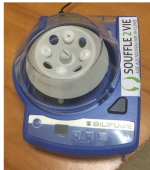
Centrifugeuse « bilifuge » qui permet de centrifuger le sang pour séparer les cellules et le sérum.
