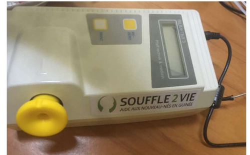
Photomètre « bilimeter 3 » qui mesure la bilirubinémie.
